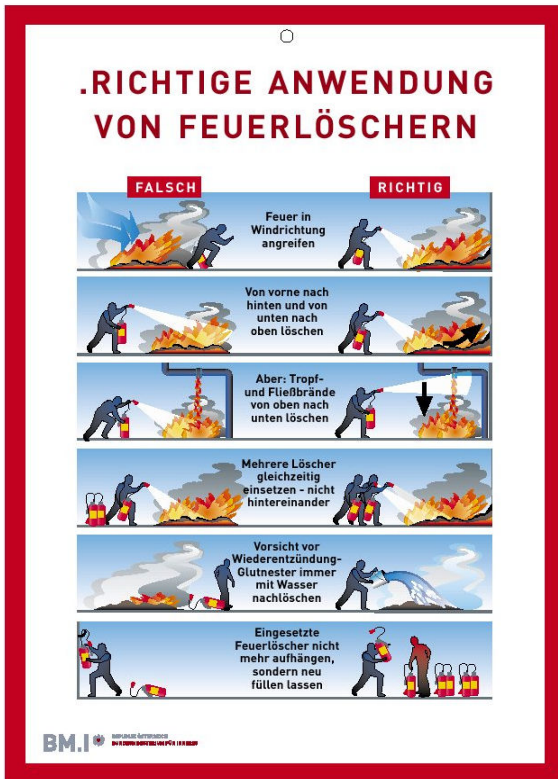
Abb. 5.1: Benützung eines Handfeuerlöschers (Quelle: TRVB O 119 06, S. 15)
