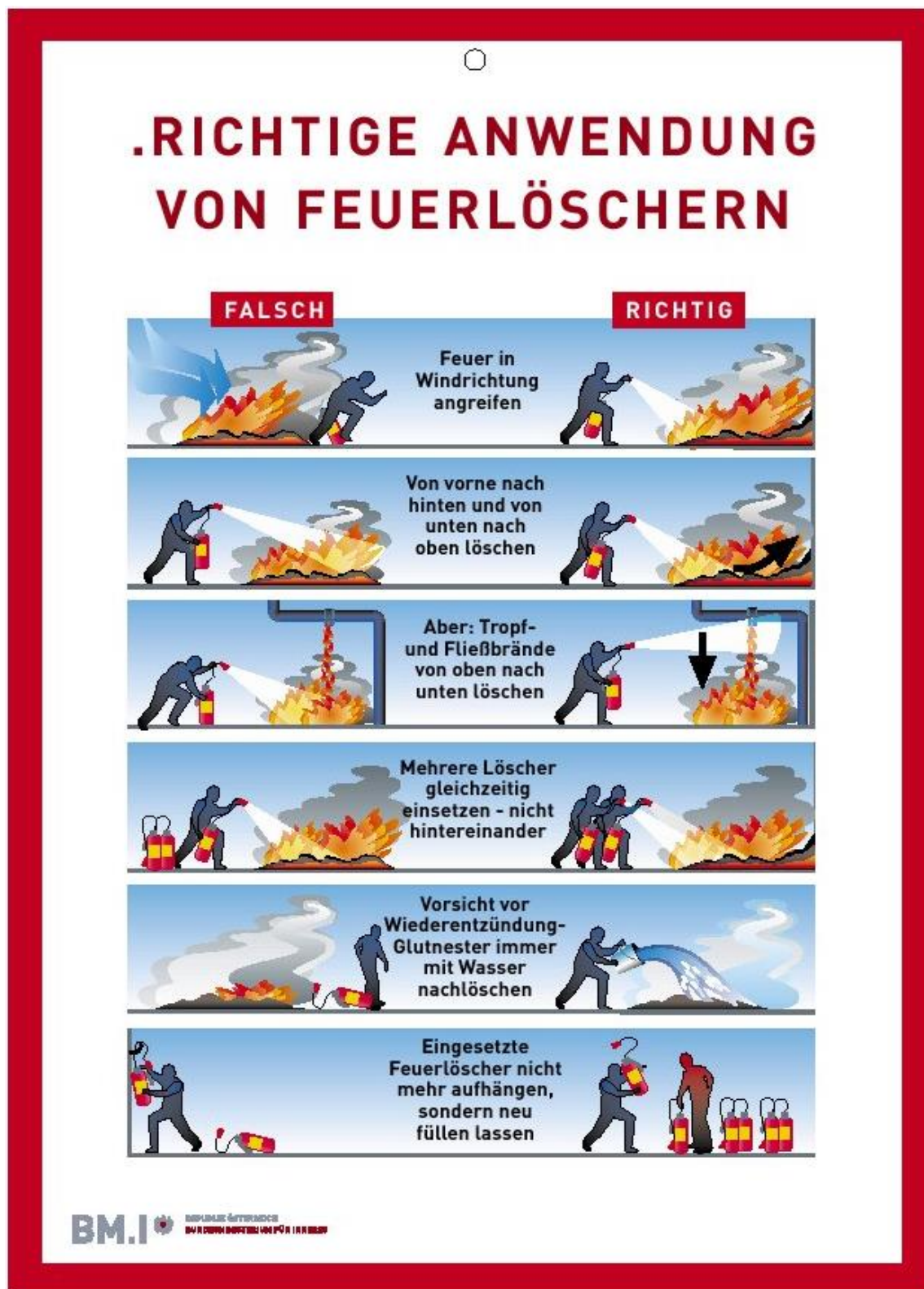
Abb. 5.1: Benützung eines Handfeuerlöschers (Quelle: TRVB O 119 06, S. 15)
