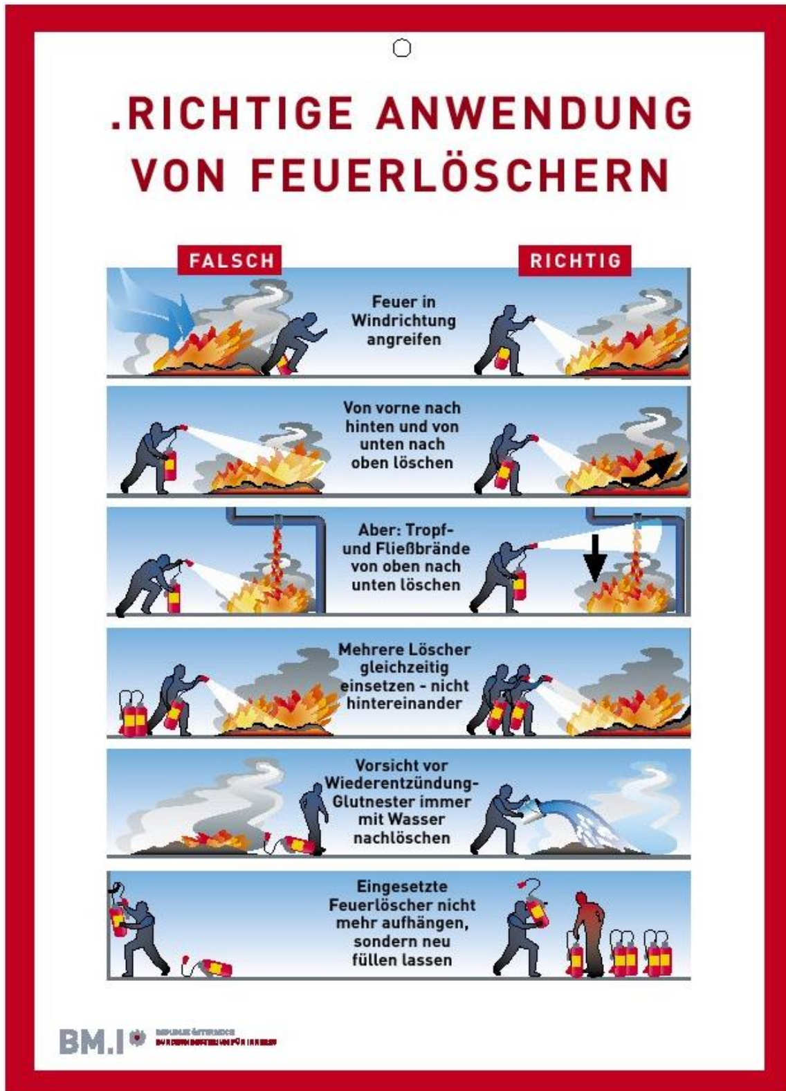
Abb. 5.1: Benützung eines Handfeuerlöschers (Quelle: TRVB O 119 06, S. 15)
