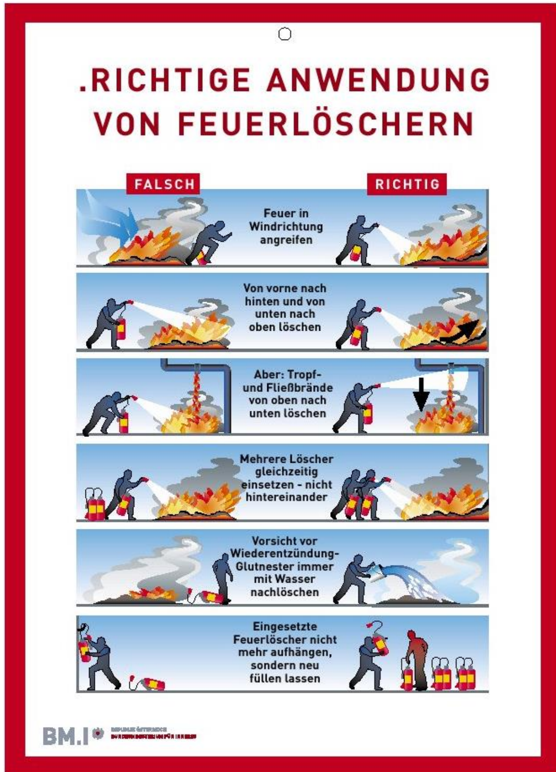
Abb. 5.1: Benützung eines Handfeuerlöschers (Quelle: TRVB O 119 06, S. 15)
