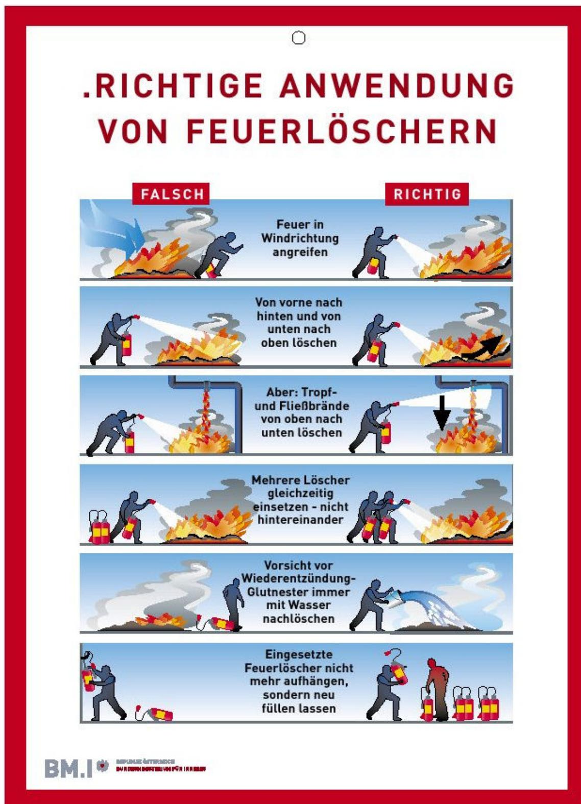
Abb. 5.1: Benützung eines Handfeuerlöschers (Quelle: TRVB O 119 06, S. 15)
