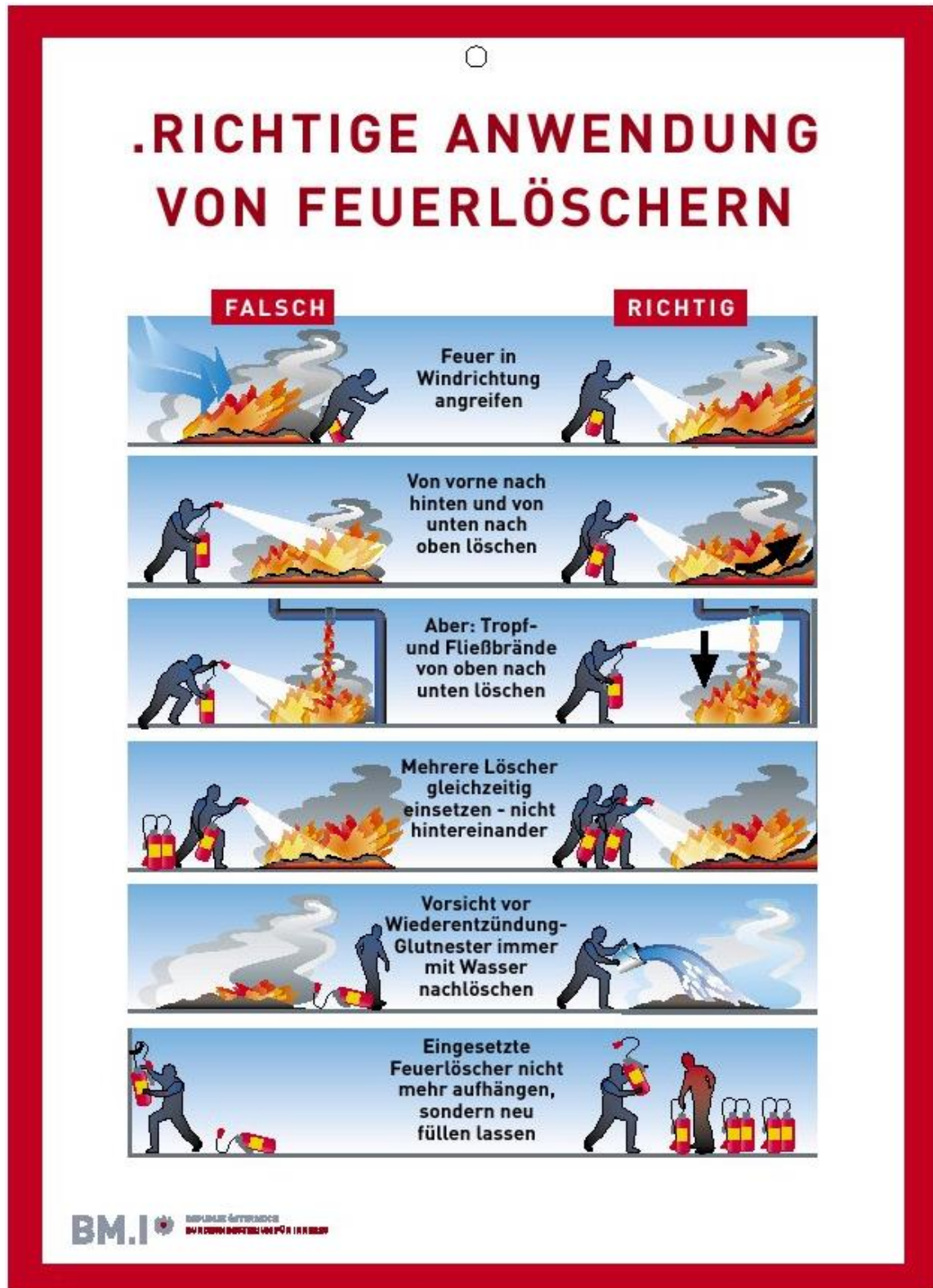
Abb. 5.1: Benützung eines Handfeuerlöschers (Quelle: TRVB O 119 06, S. 15)
