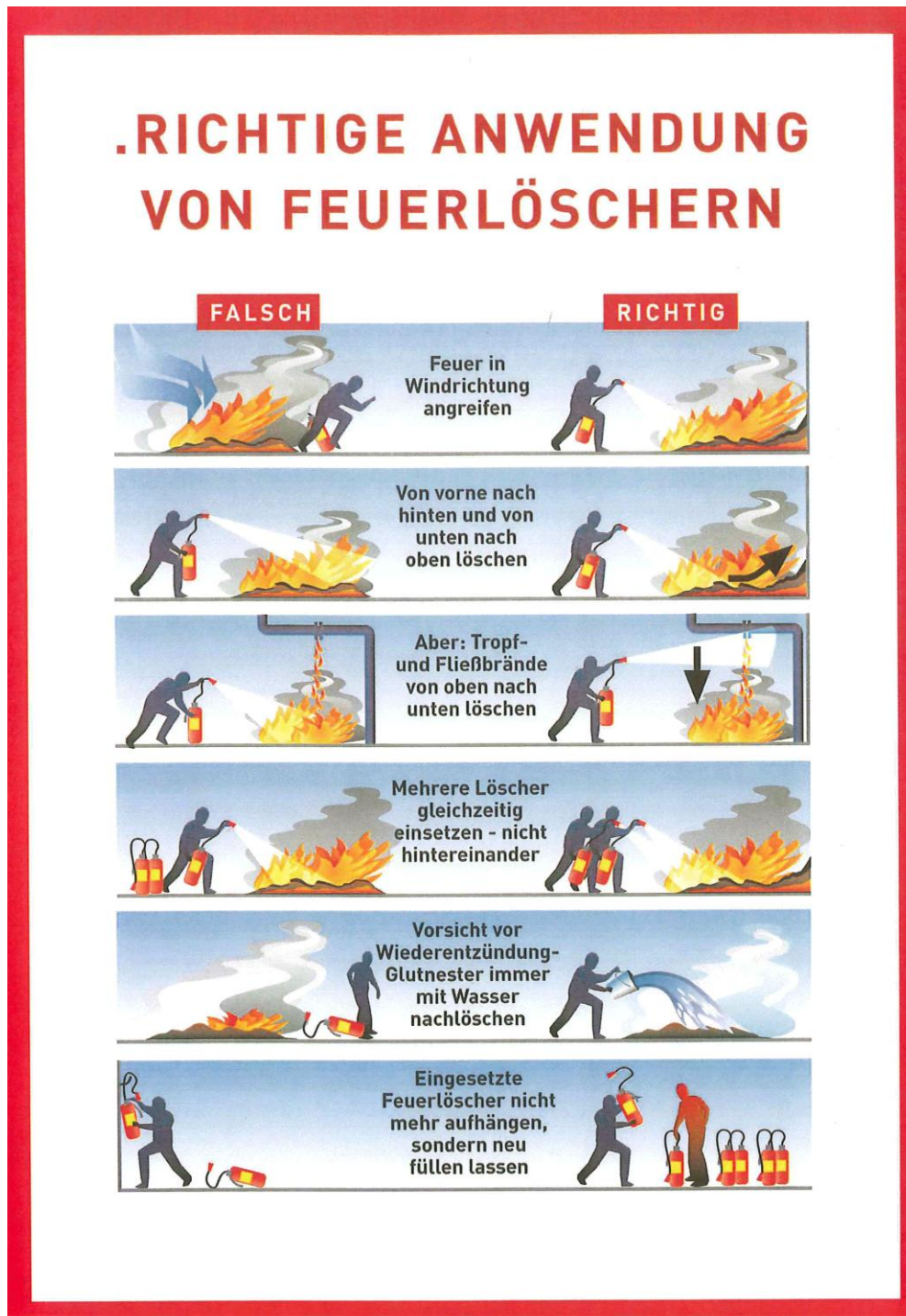
Abbildung 1: Benützung eines Handfeuerlöschers (Quelle: TRVB O 119 06, S. 15)
