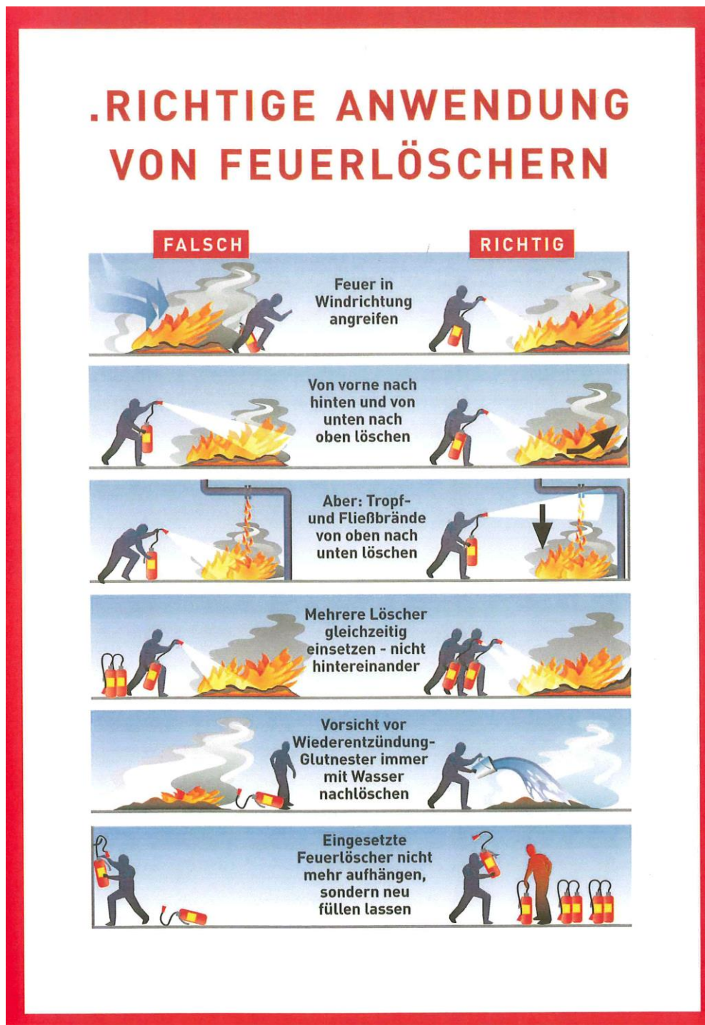
Abbildung 4: Benützung eines Handfeuerlöschers (Quelle: TRVB O 119 06, S. 15)
