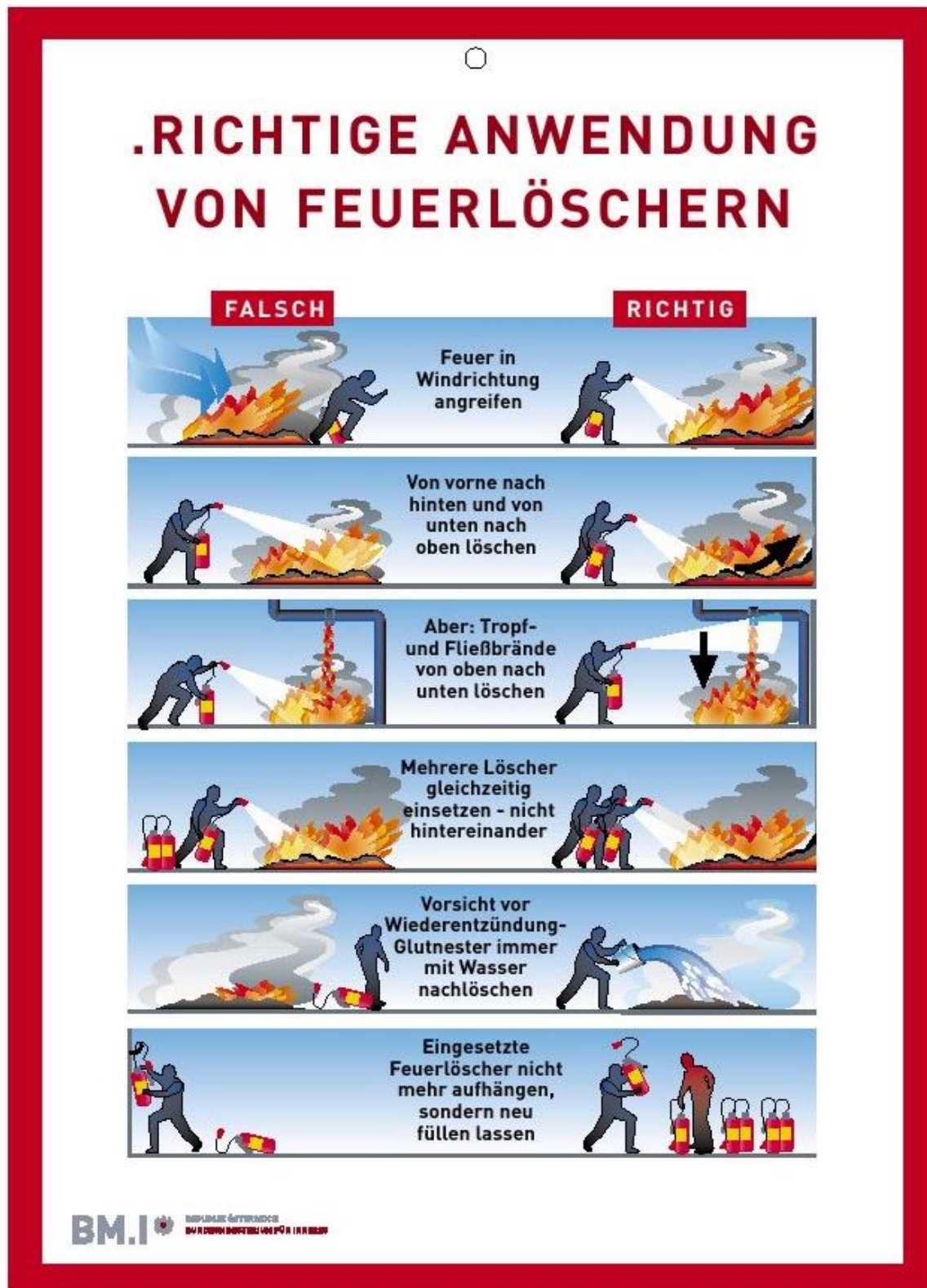
Abb. 5.1: Benützung eines Handfeuerlöschers (Quelle: TRVB O 119 06, S. 15)
