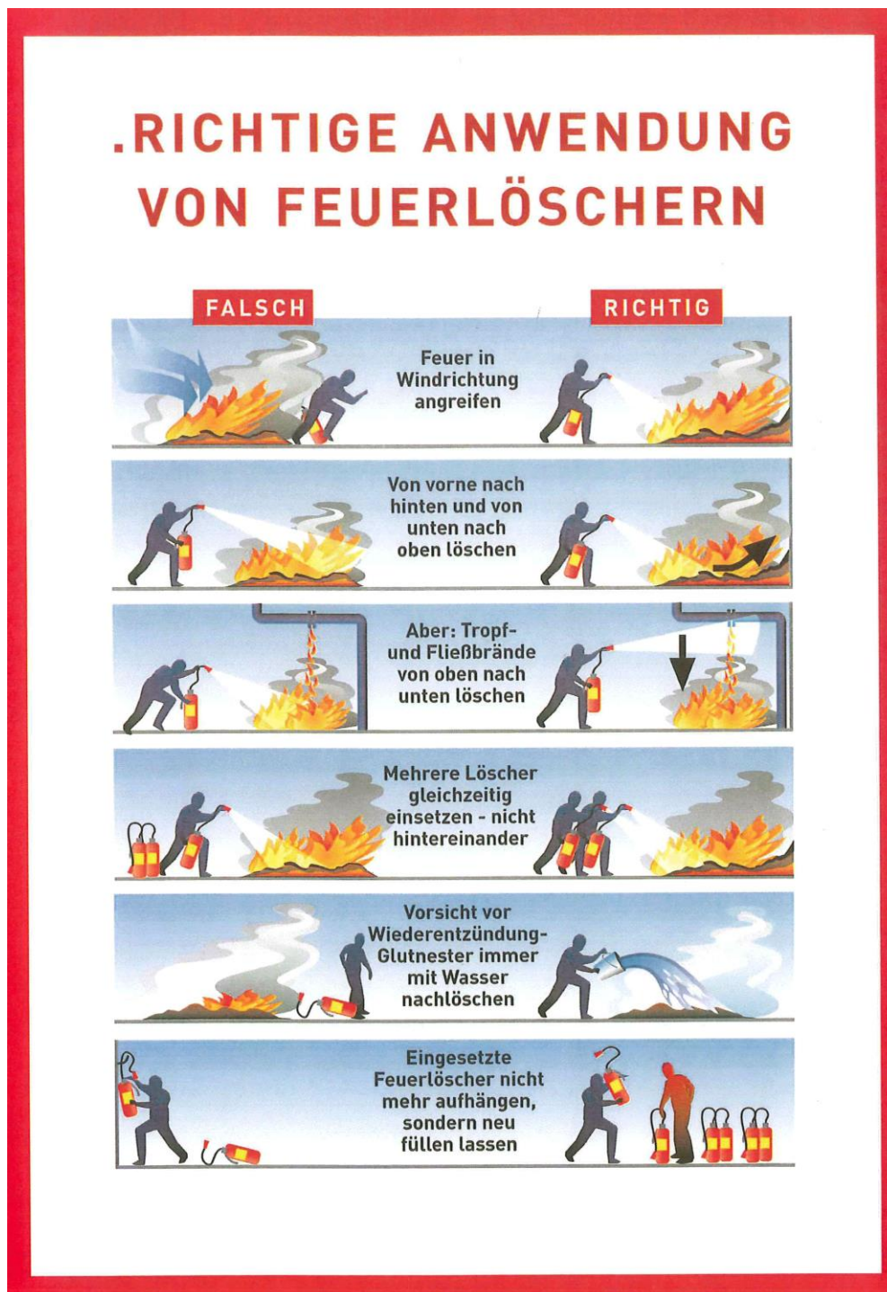
Abbildung 3: Benützung eines Handfeuerlöschers (Quelle: TRVB O 119 06, S. 15)
