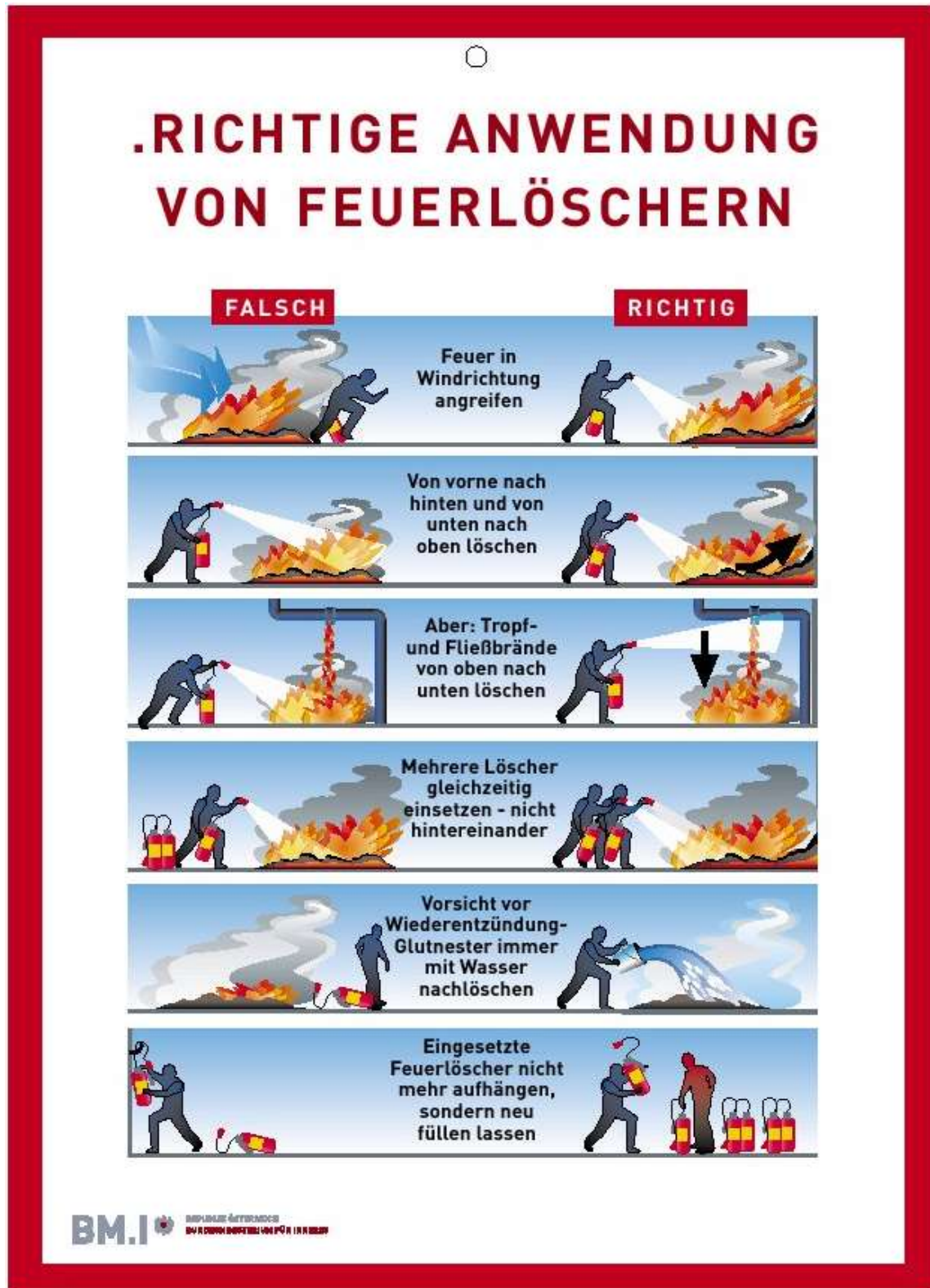
Abb. 5.1: Benützung eines Handfeuerlöschers (Quelle: TRVB O 119 06, S. 15)
