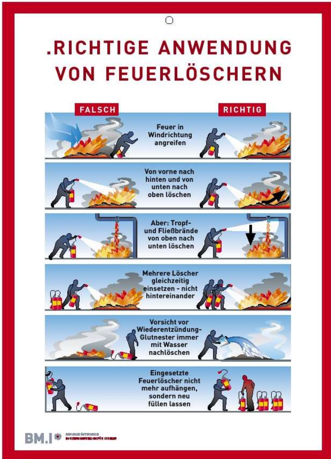
Abb. 5.1: Benützung eines Handfeuerlöschers (Quelle: TRVB O 119 06, S. 15)
