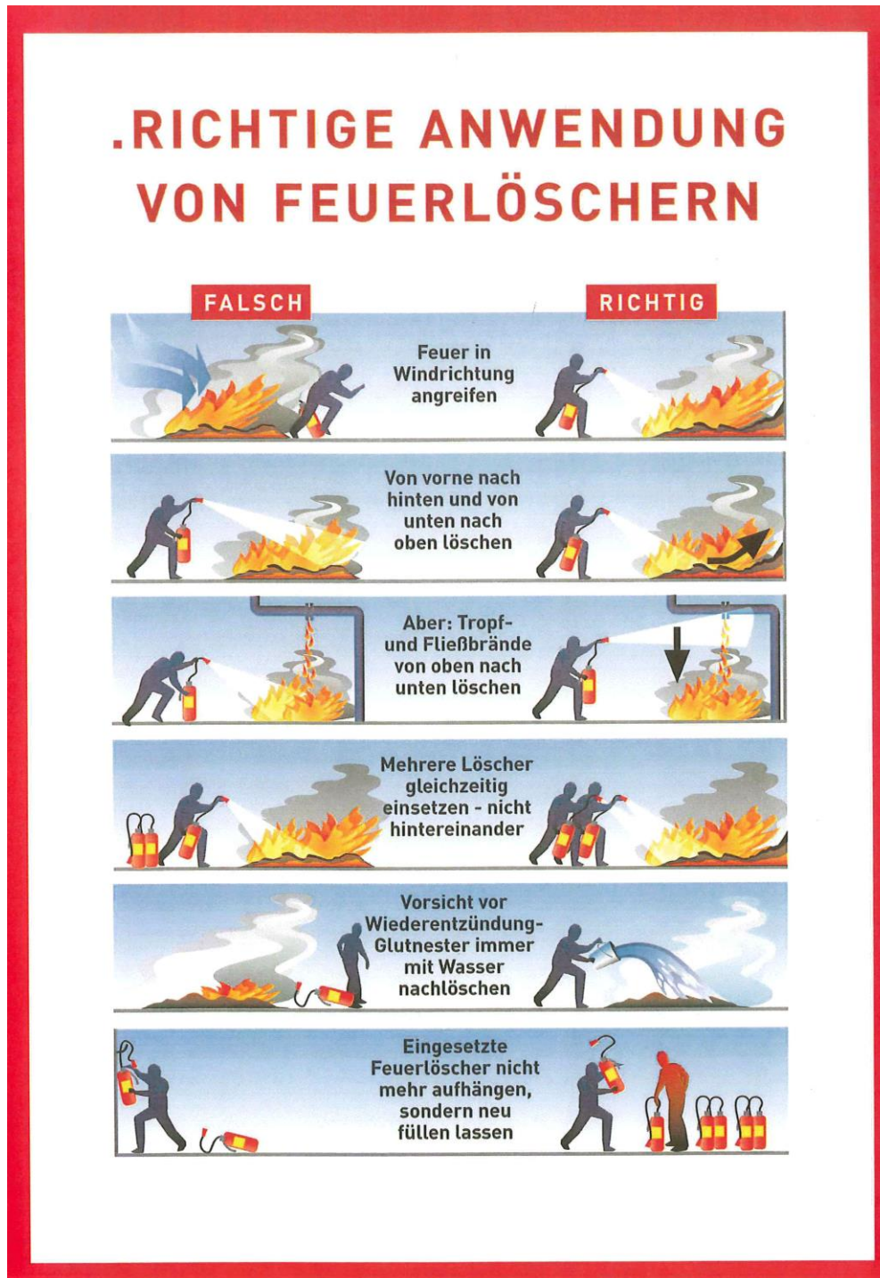
Abb. 1: Benützung eines Handfeuerlöschers (Quelle: TRVB O 119 06, S. 15)
